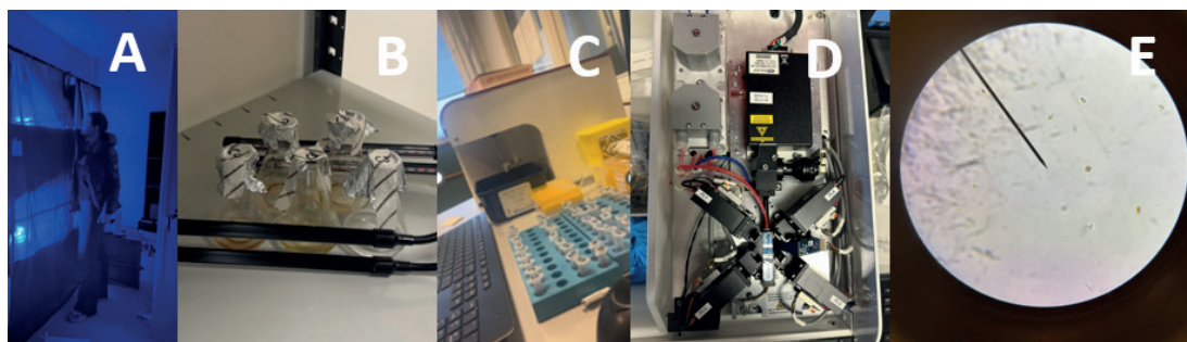
Figur 1: (A) Oppsettet for vekst for de seks lysintensitetene, der hver lysintensitet er plassert i egen hylle. (B) Lysoppsettet med de 5 parallellene. (C) Flowcytometriinstrumentet og prøverørerne. (D) Lasersystemet inni flowcytometriinstrumentet. (E) Mikroalgen R. salina . Sett i mikroskop.
