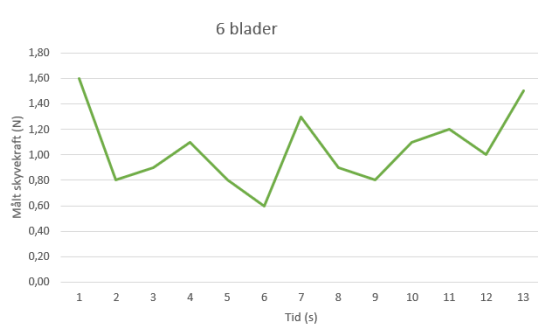
Figur 4: Målinger av propell med 6 blader
