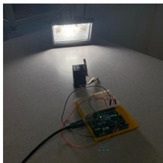
Bilde 4: Arduino oppsett med lyskilde og kyvettehus
