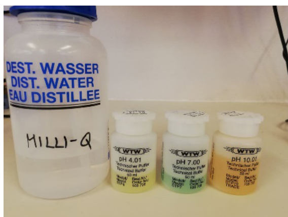
Buffer med pH på 4,01, 7,00 og 10,01 og destillert vann fra NMBU og utstyr som ble brukt i studien. Foto: Privat
