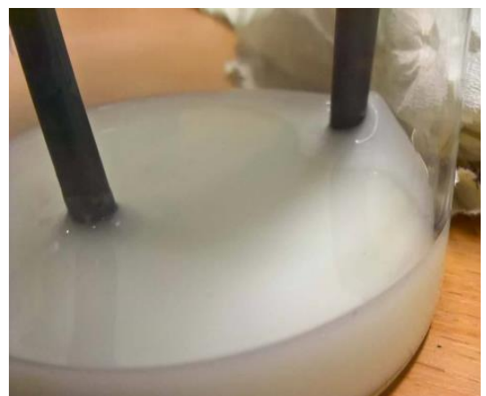
Figur 4 Bilde av pastadannelse ved katoden under elektrolyse av 10ml melk ved bruk av kullelektroder og en 12V likespenningsskilde.
