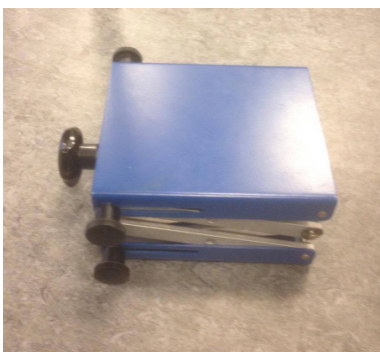
Figur 1: Liften brukt i forsøket. Den kan skrues til høyere og lavere høyde. Brukt for å hindre rykking.
