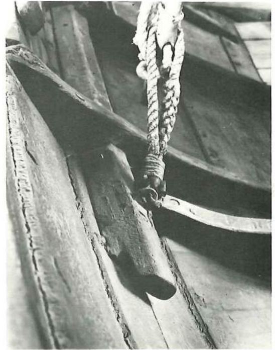
Fig 16-14 Sheat cleat cut on the end of the inwale. 6-oared boat from Sunnmøre. Norsk Sjøfartsmuseum, Bygdøy, Oslo
